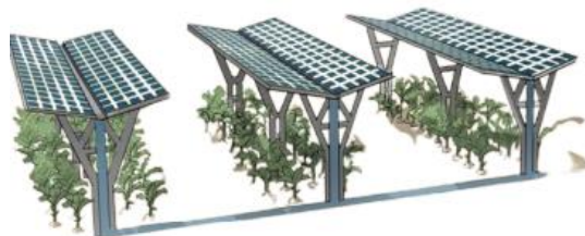
Figura 7. Configuración sistema fijo inclinado. Fuente: [33].
