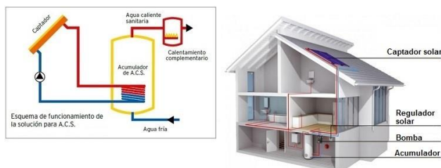
Figura 2. Esquema de funcionamiento de un CSCA, Fuente: [10]
