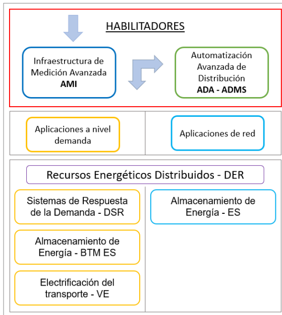
Figura 2. Tecnologías habilitadas por la Infraestructura de Medición Avanzada. Fuente: Elaboración propia basado en [19].
