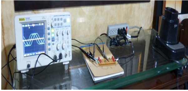
Figura 9. Arquitectura del circuito implementado para realizar las mediciones, de derecha a izquierda: osciloscopio, tapón y dispositivo de medición (Licuadora).
