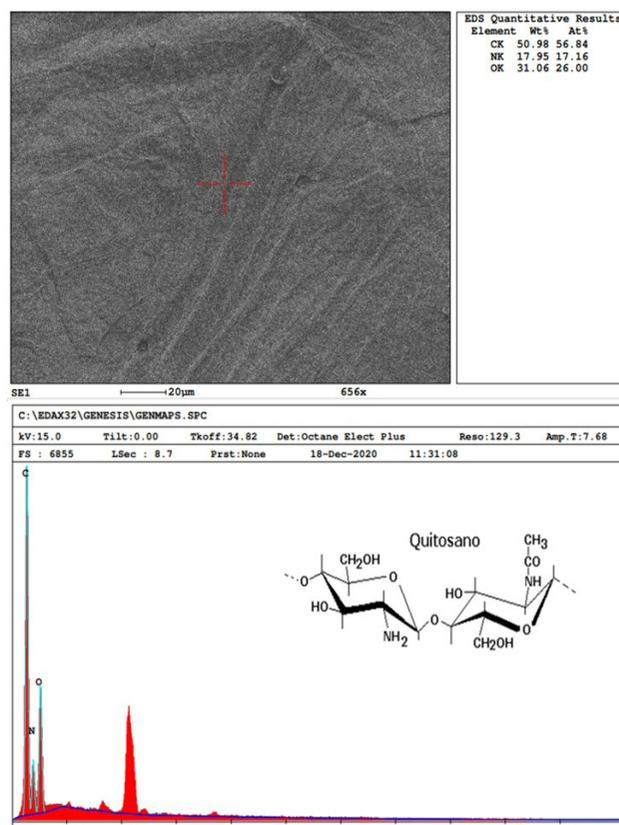
Figura 9. Análisis microscópico para de determinación de elementos principales en las moléculas y espectro de rayos x de energía dispersa (EDS) para quitosano de crisálida de *Bombyx mori* L. Fuente: autores.
