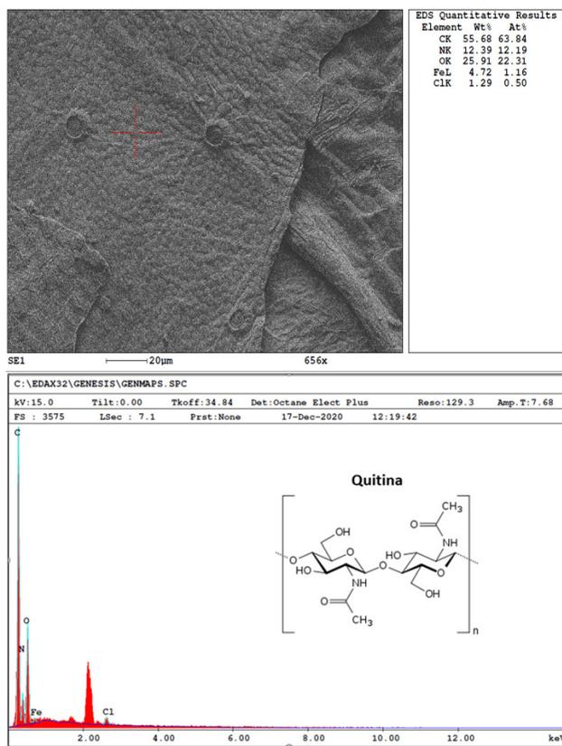
Figura 8. Análisis microscópico para de determinación de elementos principales en las moléculas y espectro de rayos x de energía dispersa (EDS) para quitina de crisálida de *Bombyx mori* L. Fuente: autores.
