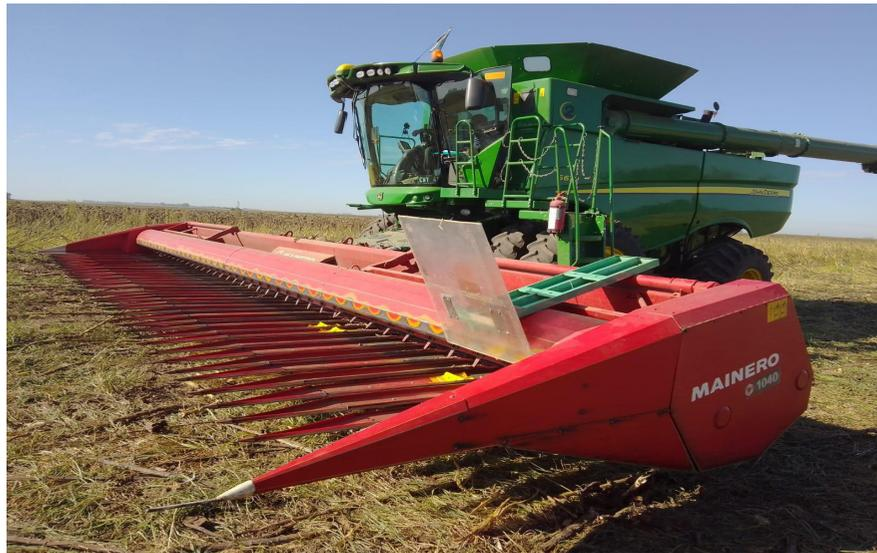
Figura 1. Distribución del escudo en el cabezal prototipo y original.
