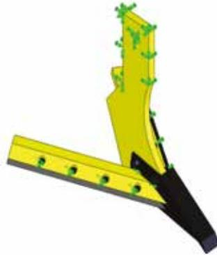
**Figura 3.** Definición de las restricciones del modelo.
