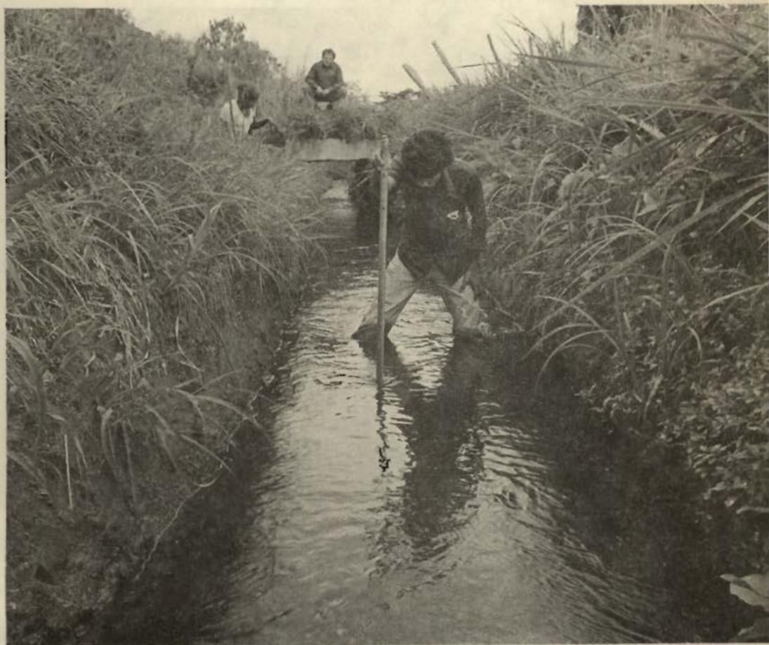
**Fig. 1. Aforo sobre la acequia Lomitas con la varilla hidrométrica**
