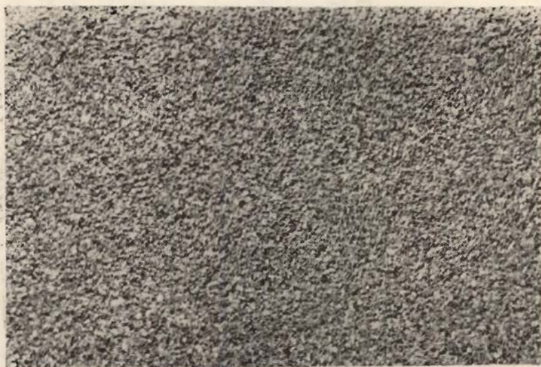
FIGURA 5.— 70% de partículas primarias. Obsérvese que las partículas primarias, puntos blancos, son mayores que los agregados, puntos grises.
