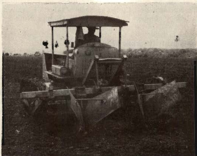
Figura 3. — Este equipo, no es propiamente un subsolador pero hace las veces de tal quitándole las vertederas.
