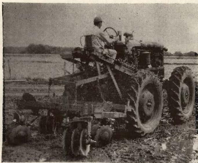
Figura 4. — Aporcador acoplado en un tractor listo para hacer la labor de aporque.
