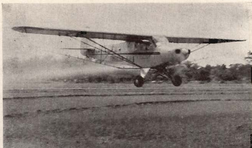
Fig. No. 3.— Avioneta fumigadora trabajando. Distancia entre las ruedas y la tierra más o menos 1 metro.
