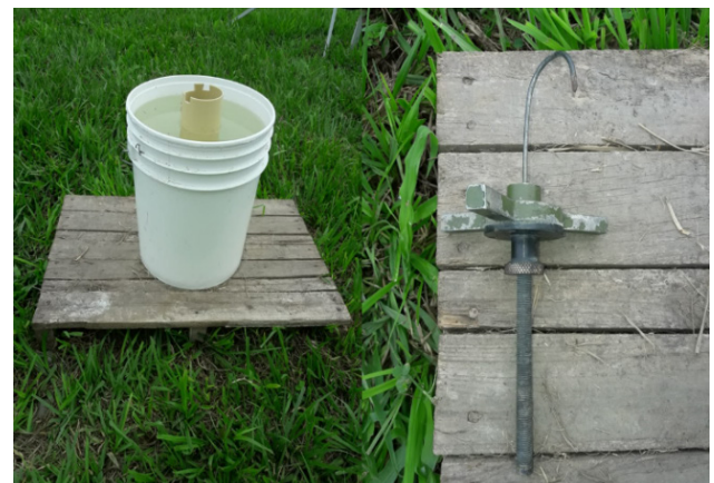
Figura 2. Foto del tanque cenirrómetro y el tornillo micrométrico.
