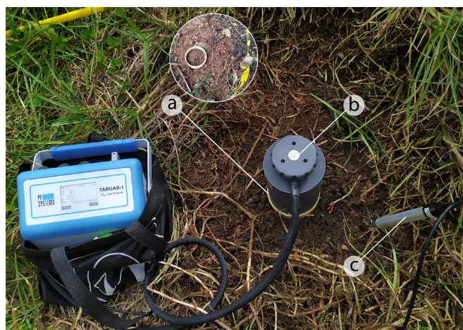
Figura 1. Analizador de gases infrarrojos (IRGA) para la medición del flujo de CO 2 del suelo. (a) collar de PVC, (b) cámara de respiración SRC-2 y (c) sonda de temperatura STP-2.
