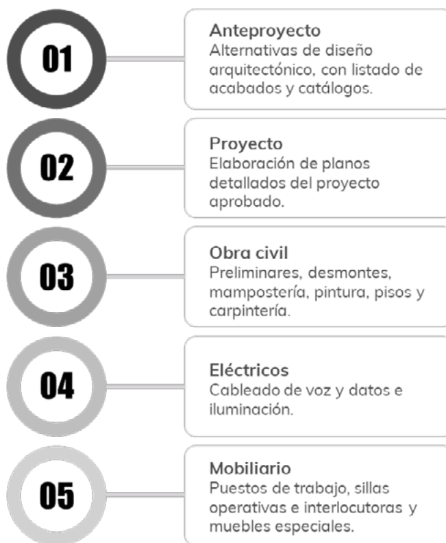
Figura 1. Proceso constructivo de la remodelación.
