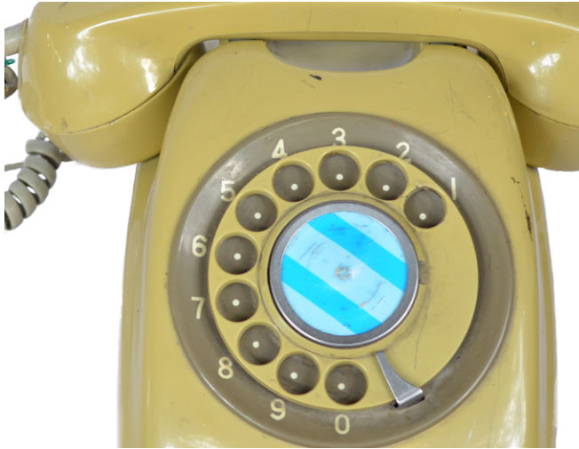
Figura 7. Dial en forma de disco del teléfono de mesa Modelo 0176 Emcali.
