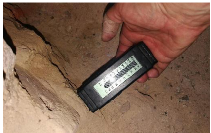
Figura 8. Medición de la humedad por resistividad (2017)
