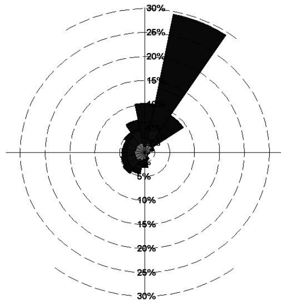
Figura 6. Rosa de direcciones de viento para la serie de Reanálisis utilizada en las simulaciones
