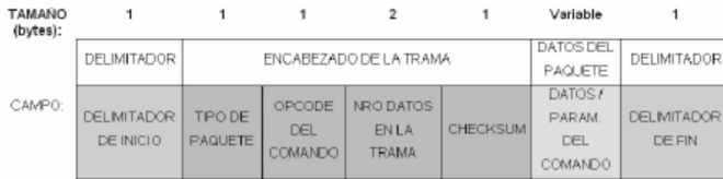
Figura 4. Formato de la trama de comandos a nivel de aplicación.
