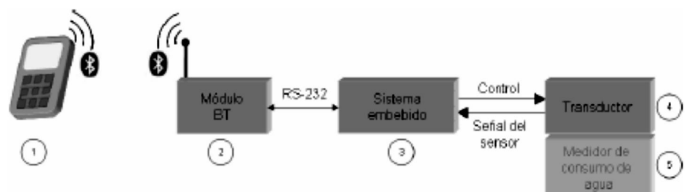
Figura 3. Diagrama de bloques del sistema.
