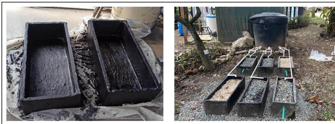
Figura 2. Construcción de los humedales artificiales: a) Construcción de humedales en concreto e impermeabilización. b) Sistema de humedales con materiales de soporte.
