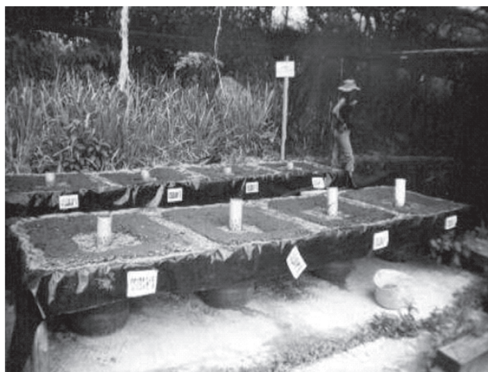
Figura 2. Disposición de las 8 biopilas para el trabajo de campo.
