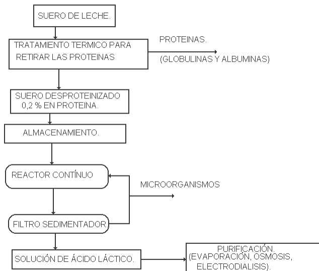
Figura 1. Esquema de proceso para la conversión de suero de leche en ácido láctico, en un reactor continuo de tanque agitado.
