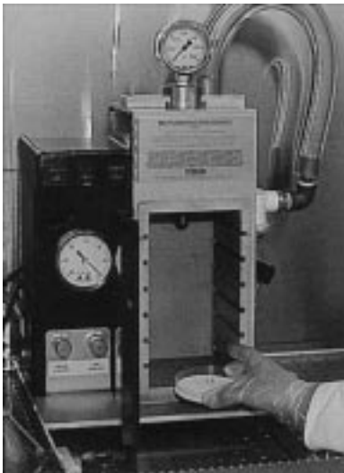
Pistola Genética: dispositivo que dispara micro proyectiles( esferas diminutas de tungsteno o de oro de 4 micrómetros de diámetro), recubiertos con el ADN foráneo que se quiere introducir en las células.
