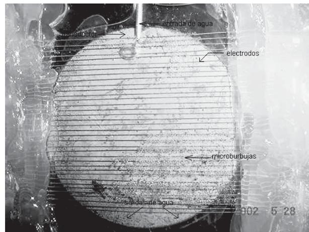
Figura 3. Fotografía de las microburbujas formadas sobre la rejilla de electrodos en la cámara ultrasónica.
