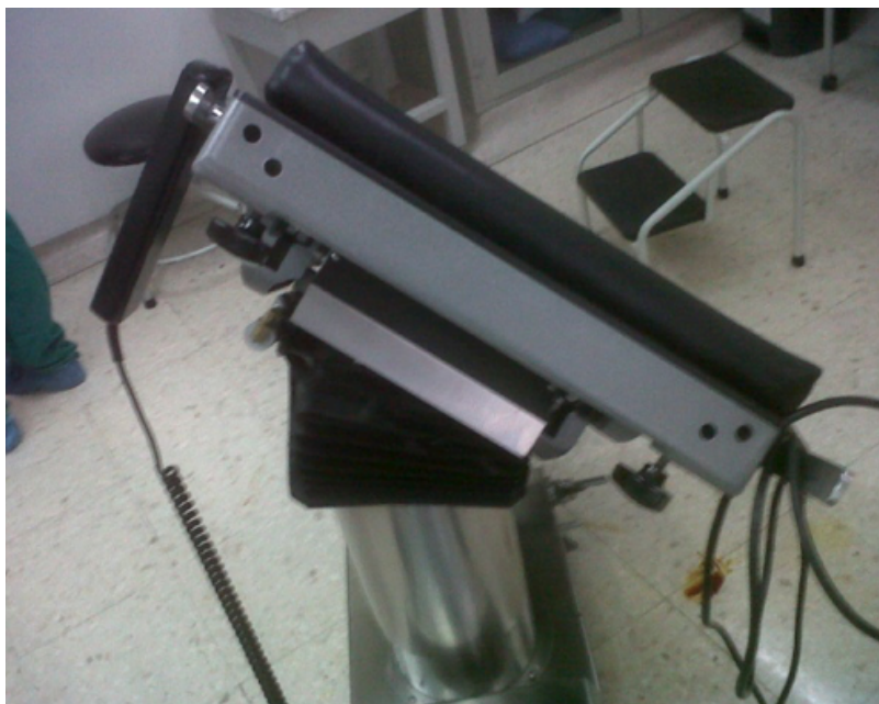
Fig 1. Estado de la mesa quirúrgica luego de la fractura. Fuente: Elaboración propia
