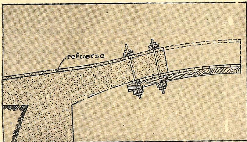
construido, pero una vez cerrado éste, quedaba inútil. Se hubiera podido proyectar un arco elástico, con armadura para resistir tensión, con lo cual quedara utilizada ésta después de terminada la obra. Con todo, la construcción resultó muy económica, pues la armadura valía mucho menos de lo que hubiera costado una cimbra de toda la luz.
