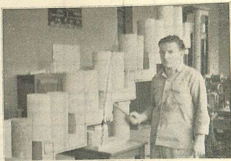
El operador señala el punto donde se presentó la 1ª fisura
