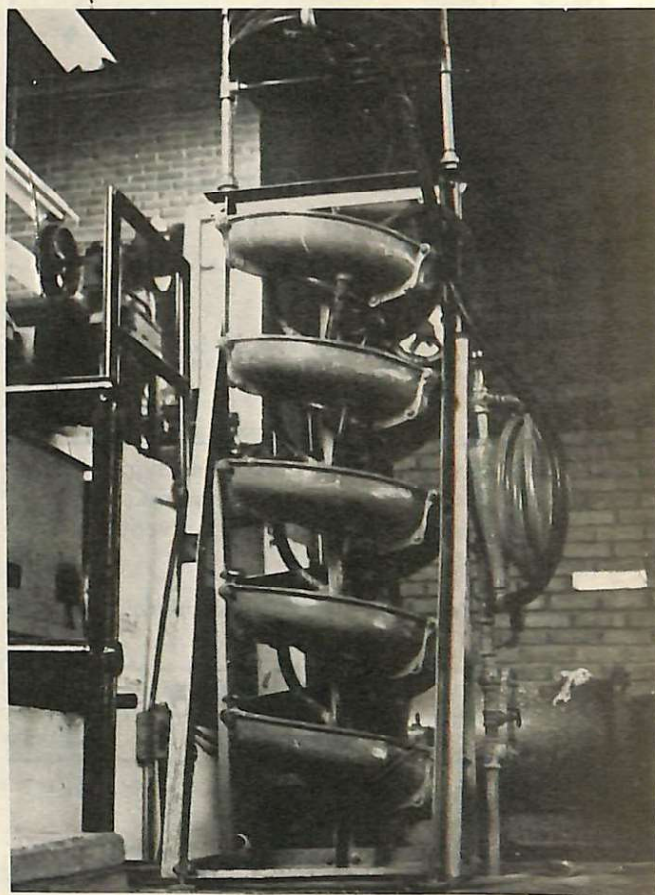
"Concentrador gravitacional en espiral (tipo Humphrey) de la planta piloto de concentración de minerales del CENTRO DE INVESTIGACION DEL COBRE. Fotografía de Guillermo Enrique Escobar".
