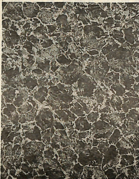
Fotografía # 2: Material base soldado, 100X
