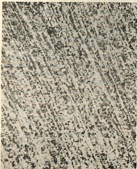
Fotografía # 1: material base sin soldar 100X
