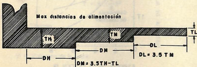
Figura 3. Distancias de alimentación en láminas de sección doble
