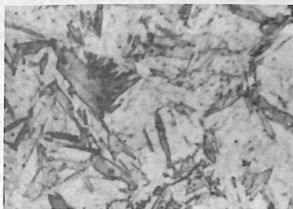
Figura 7. Muestra templada en aceite. Martensita mixta. Ataque nital 2%, 1050X
