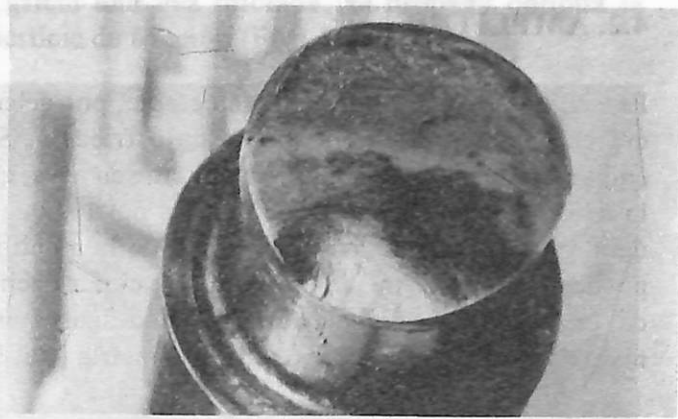
Figura 4 Falla por fatiga de una barra impulsora. Se inicia por fatiga bajo fricción en un ajuste de la barra, 0.8X (Ref.10).
