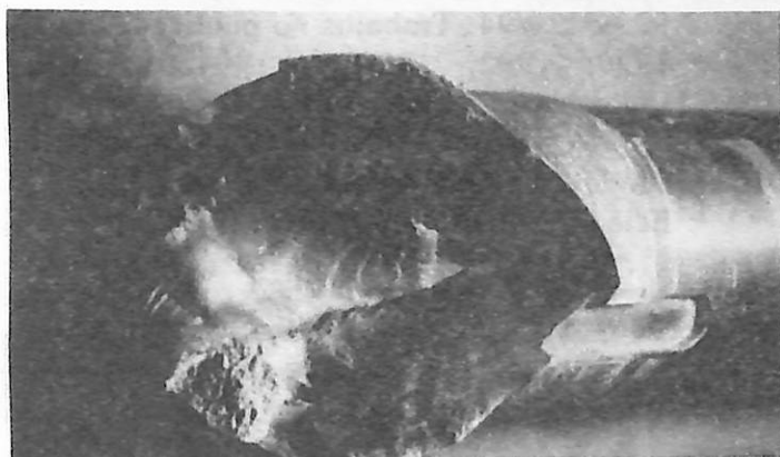
Figura 6 Eje de telar Sulzer, que falló por fatiga bajo fricción, por esfuerzos de torsión en sentido opuesto con origen en la superficie cilíndrica (arriba) y en la base del chavetero. 0.80X (Ref.10).
