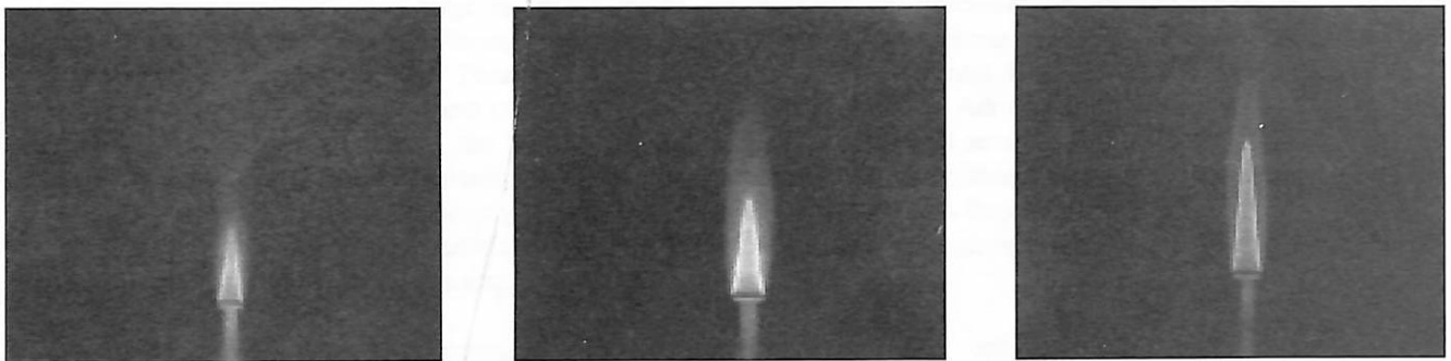
Figura 5. Efecto de la Velocidad de Salida de la Mezcla Inflamable sobre la Altura del Cono
