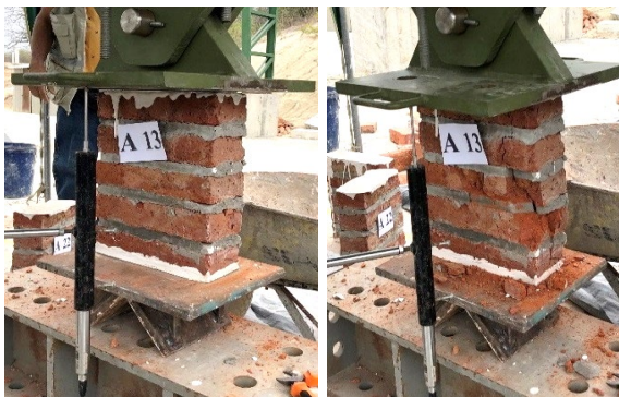
Figura 5. Prismas de la ciudad de Santa Ana. Antes y después del ensayo Fuente: Fotografías tomadas por los autores
