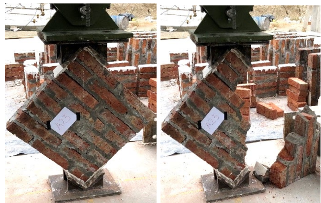
Figura 8. Murete de la ciudad de Santa Ana. Antes y después del ensayo Fuente: Fotografías tomadas por los autores
