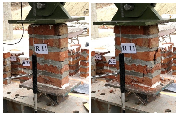
Figura 4. Prismas de la ciudad de Rocafuerte. Antes y después del ensayo. Fuente: Fotografías tomadas por los autores
