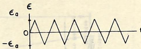
Ensayo controlando la deformación.
