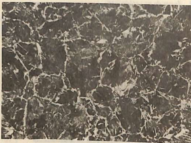
ZONA AFECTADA TERMICAMENTE. 100 X. Configura a la línea de fusión, obsérvese el crecimiento del grano.
