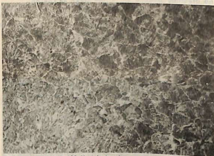
LINEA DE FUSION. 100 X. A la derecha se ve el material de aparte, a la izquierda, la zona afectada térmicamente (Grano grande).
