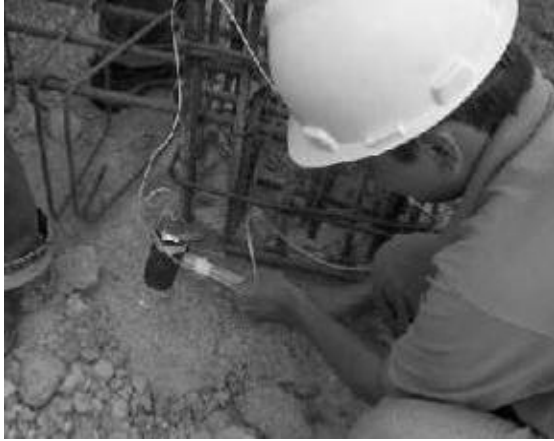
Figura 5. Impacto con el martillo sobre la superficie Figure 5. Hammer impact on the pile surface
