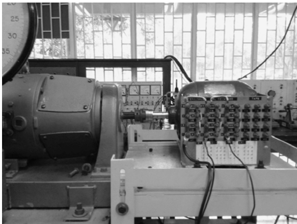
Figura 3. Generador CC acoplado al motor de inducción.
