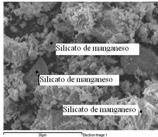
Figura 9. Caracterización del manganeso. SEM/EDS.
