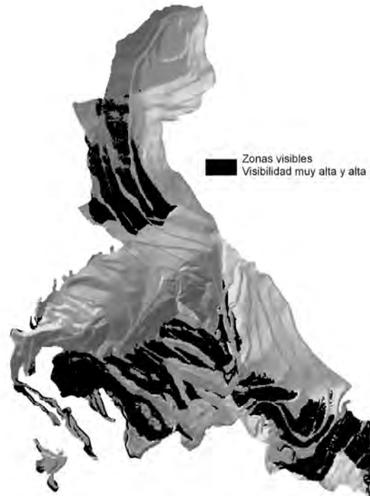
Figura 3. Visibilidad de la mina Feixolín en cada unidad de paisaje desde zonas frecuentadas por la población (núcleos de población y carreteras)
