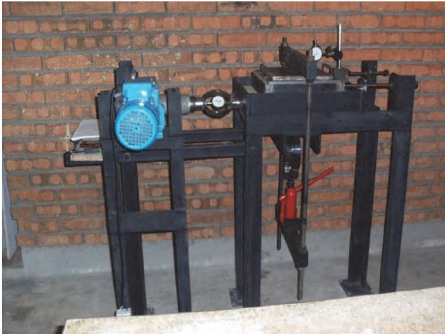
Figura 2. Fotografía del equipo de corte construido Fuente: Los autores
