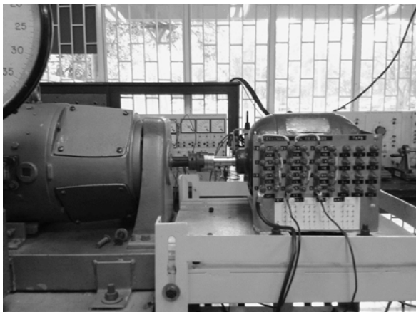
Figura 3. Generador CC acoplado al motor de inducción.
