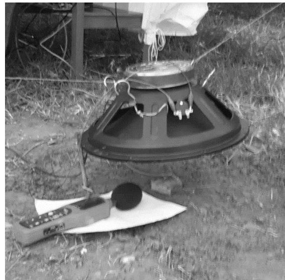
Figura 3. Perturbación acústica del suelo mediante un parlante. Las medidas de la aceleración y presión del aire en la superficie se hacen mediante un acelerómetro y un sonómetro.
