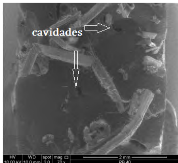
H0.1 (9) Microscopía de barrido (SEM) en la superficie de falla de una probeta de ensayo a tensión indicando la distribución no homogénea de las fibras.
