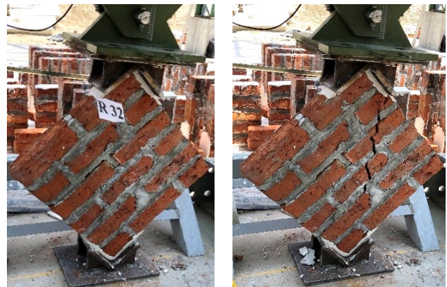
Figura 7. Murete de la ciudad de Rocafuerte. Antes y después del ensayo Fuente: Fotografías tomadas por los autores
