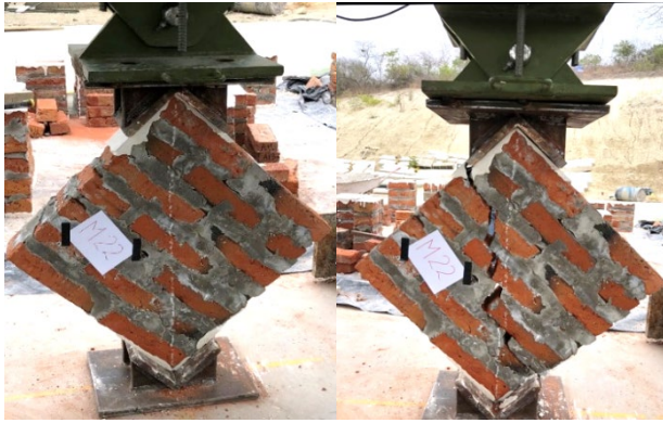
Figura 9. Murete de la ciudad de Montecristi. Antes y después del ensayo Fuente: Fotografías tomadas por los autores
