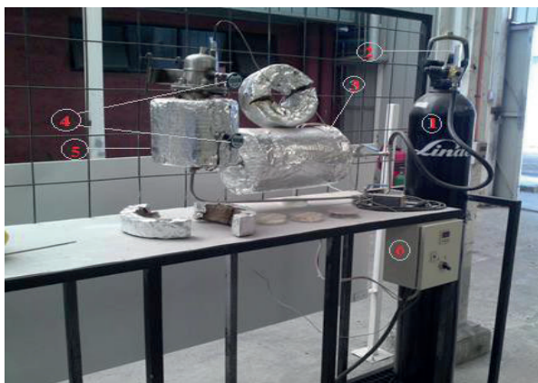
Figura 2. Instalación de laboratorio. Torrefacción seca. 1-Balón de N 2 , 2- Regulador de caudal, 3- Calentador, 4-Indicadores de Temperatura, 5-Reactor, 6- Controles
