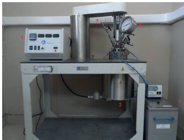
Figura 1. Esquema de laboratorio. Torrefacción húmeda. 1-Panel de control, 2- Reactor, 3-Medidor de presión, 4-Baño refrigerante, 5-Toma de gases.
