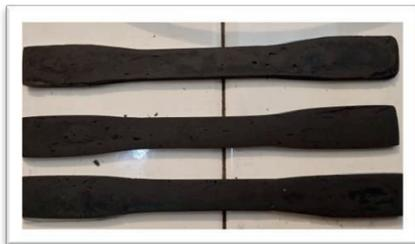
**Ilustración 15** Probetas flexión
