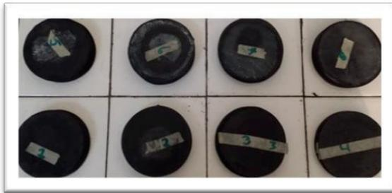
**Ilustración 13** Probetas dureza
