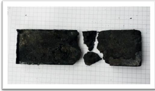
**Ilustración 22:** Mezcla de PP y residuos de minería
