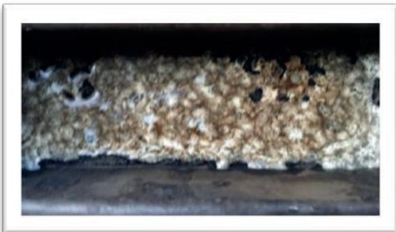
**Ilustración 4:** PP sometido a temperatura
