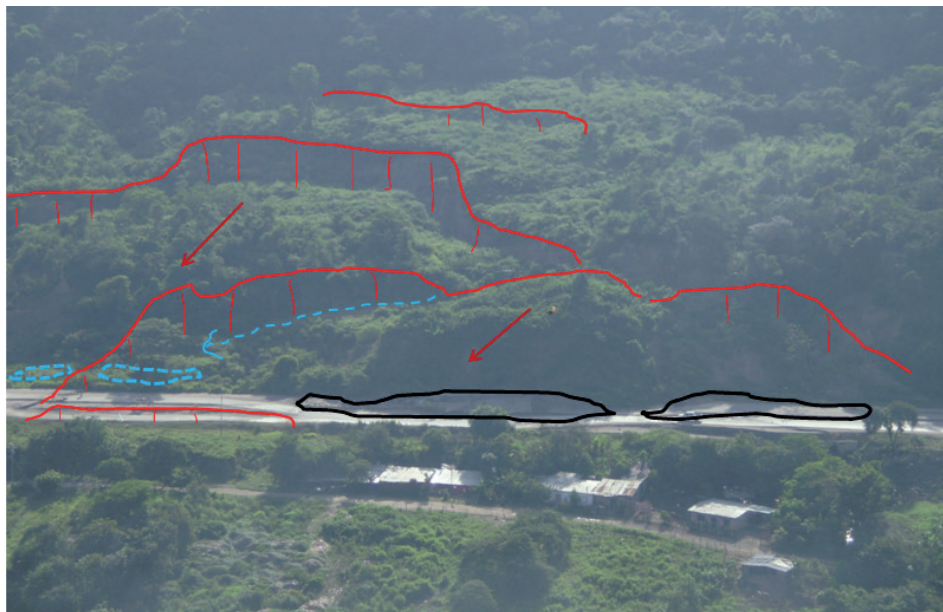
Figura 8. Señalamiento de los sectores de mayor deformación concentrados en el canal de bajada de la autopista hacia La Fría, como resultado del corte efectuado en la base de uno de los deslizamientos de gran magnitud, a la vista en el sector de Angostura. Foto: Rodríguez (2011).
