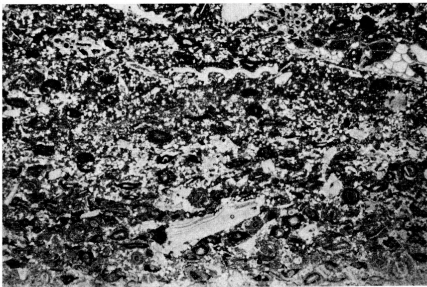
FIGURA 8. Sección delgada de la muestra AF-13 del Río Nevado. Caliza oolítica (oomicrita según FOLK, 1962) en una matriz fina con restos de plantas en la parte superior. El núcleo de las oolitas está constituido en algunos casos por foraminíferos (no reconocibles en la figura). Aumento 12X.
