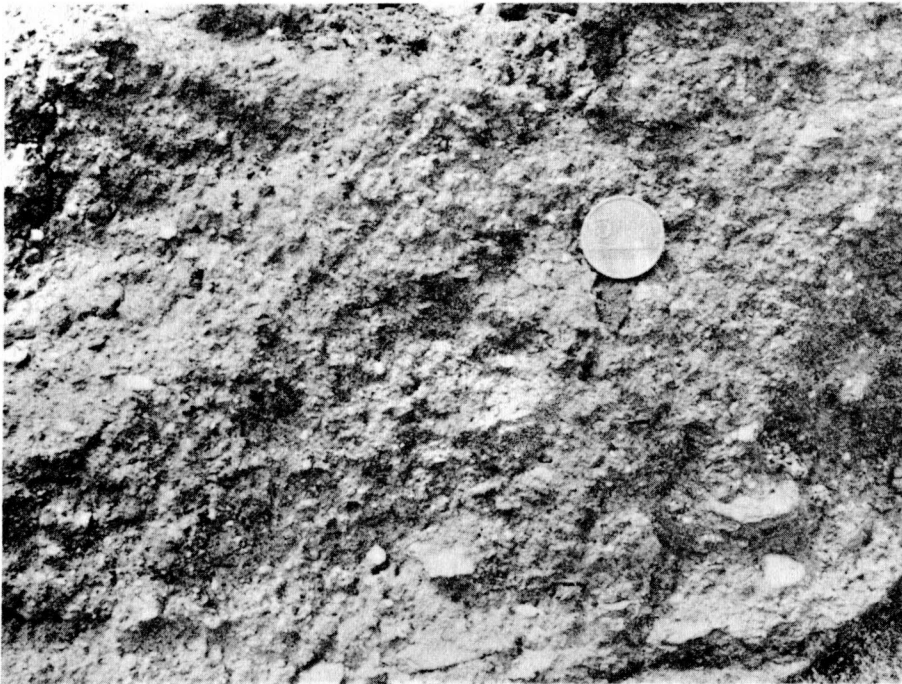
Fig. 13. Detalle del flujo más bajo mostrado en la Fig. 12. Se evidencian la mezcla caótica del material y la angularidad de los clastos, compuestos esencialmente de restos de vulcanitas andesíticas, filitas y esquistos grises y verdosos, y gránulos de cuarzo lechoso. Diámetro de la escala: 2,5 cm.
