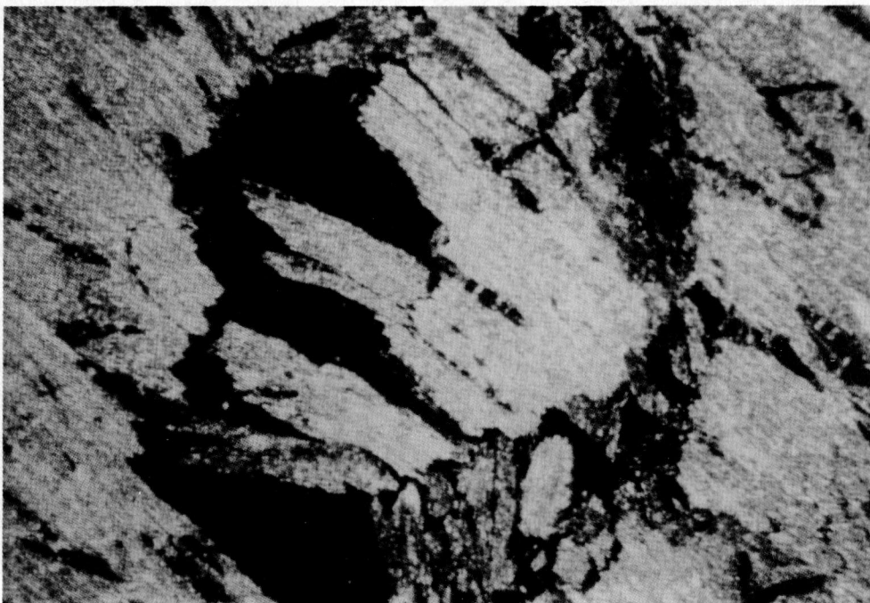
Fig. 22. Micrografía con nicoles cruzados. Pizarra con vacíos por disolución.
