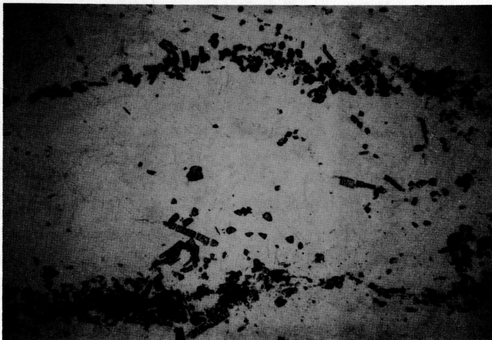
Fig. 21. Micrografía con nicoles paralelos. Se observa desarrollo de turmalina en capítas paralelas a la estratificación.
