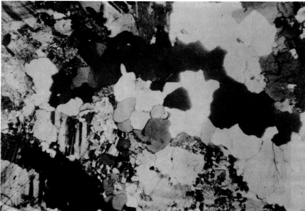
Fig. 26. Micrografía con nicoles cruzados. Granitoide producto de migmatización de metaarenisca.
