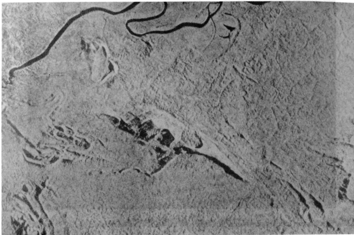
Fig. 27. Fotografía de imagen de radar. Pliegue dómico en Raudal Alto, con cima en forma de cráter, por colapso.
